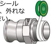
カムアームカップリングを配管やホースに取り付ける場合、右図のようにカップラーが下を向きますと、振動等によりカムアームが開く場合があります。開くと危険ですので、安全の為にセフティーピンを使用して下さい。
