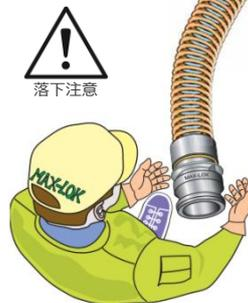
ステンレス製や銅製の大口径は、落下して足等に当たると危険です。又、アダプターのシール面が傷つくと漏れの原因になりますので注意して下さい。
