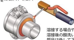
溶接後の酸洗いは、カムアームを取付ける前に行ってください。焼結金属で出来ているカムアームの場合、酸の溶液や雰囲気によってコンパウンドが溶融する事が有ります。ステンレス配管等で酸洗を行う場合も同様にカムアームを外して下さい。仕様上取り外す事が出来ない場合には、ロストワックス製のカムアームも用意していますので、弊社及び販売店にお問い合わせ下さい。
